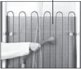
Рисунок 15 — Уборка холодильника (вид сзади)
